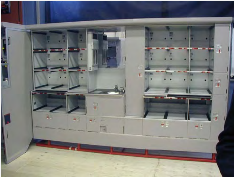
Stauraum ist knapp im Flugzeug: Die von der Bucher Leichtbau AG produzierten Galleys nutzen ihn optimal
