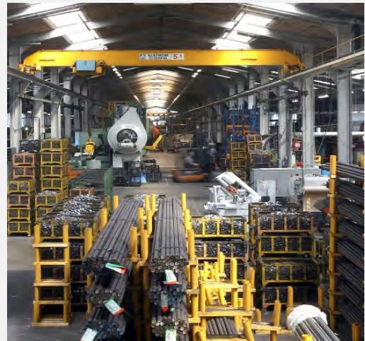
Diese 40mm starken Stabstähle werden für die Herstellung der Kugeln verwendet. Die Maschine im Hintergrund erstellt die Außenhülle.
