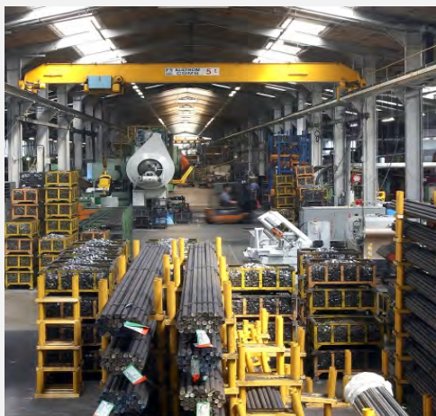
Barre di acciaio di 40 mm utilizzate per le bocce. La macchina sullo sfondo (1 di 6) è utilizzata per creare gli involucri esterni.
